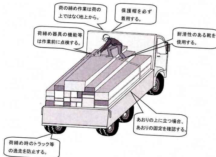
図5．荷の締め作業における基本対策
