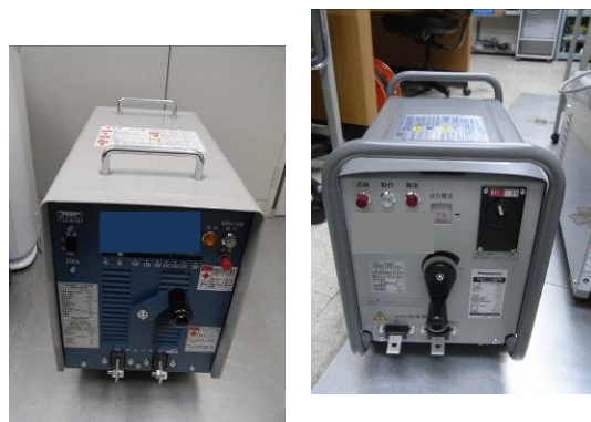
写真3 新構造規格に準拠した交流アーク溶接機用自動電撃防止装置を内蔵した交流アーク溶接機
