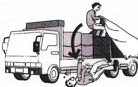
図3. 荷のシート掛け作業における災害事例
