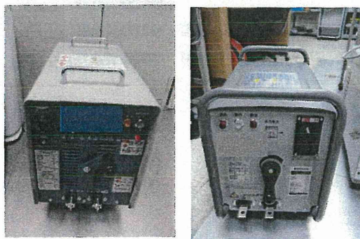
写真3 新構造規格に準拠した交流アーク溶接機用自動電撃防止装置を内蔵した交流アーク溶接機
