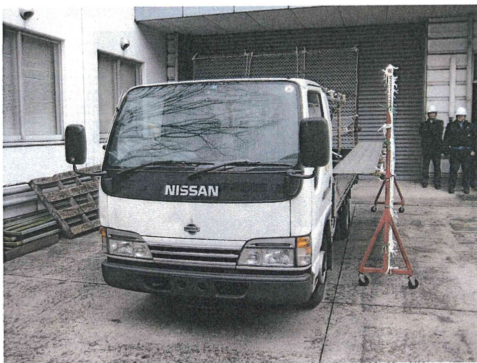
荷主庭先据置型の作業床をあおりに取り付けた状態
