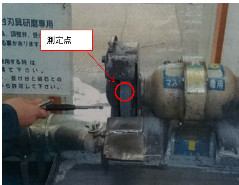
図 7.10 キャノピー式フード開口面における吸引風速の測定状況
