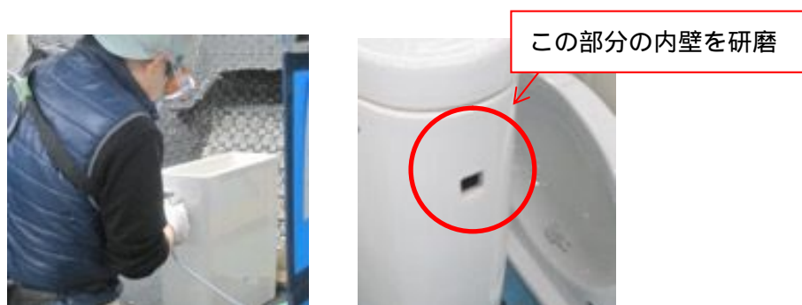
図7.23 囲い式フードを通常時の3分の1の吸引風速にした時の作業状況
