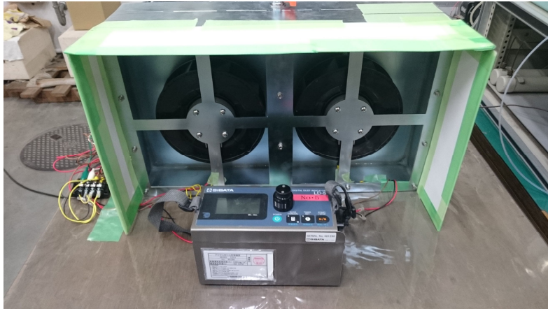
図 7.69 フィルター通過後の濃度測定状況
