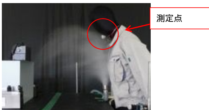
図 7.27 実験の様子(フード 1、排風量 10m 3 /min、位置 0.6m)
