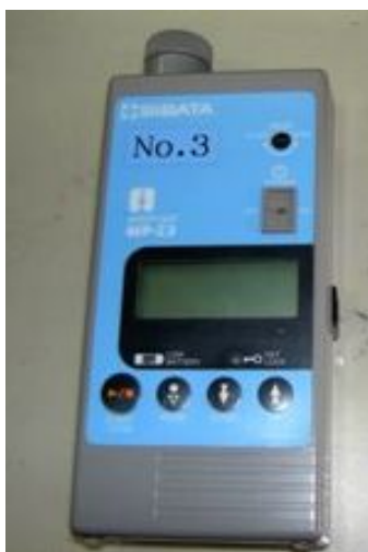
図 3.9 改良型 MP- 3 吸引ポンプの外観図
