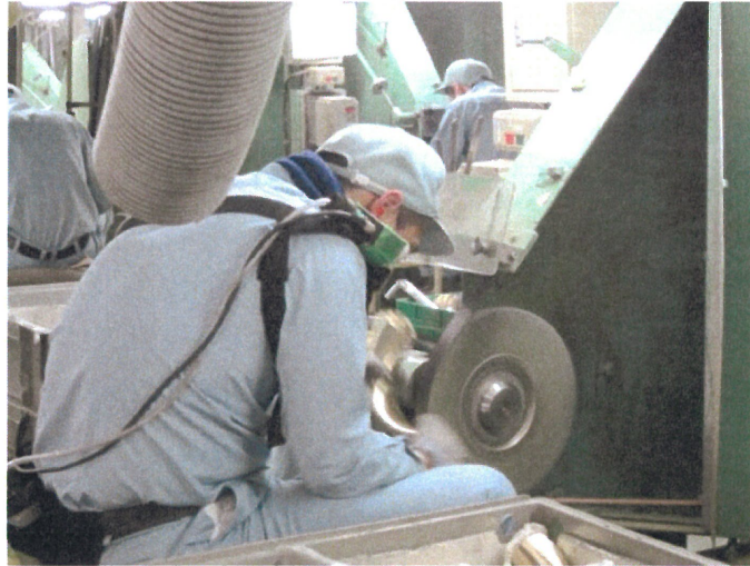
図 5.42 研磨作業の作業状況
