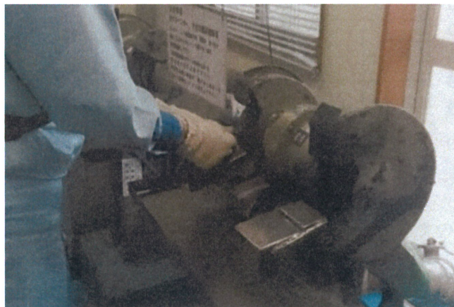
図 7.9 粉じん漏洩濃度測定時の研磨作業状況
