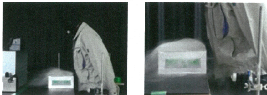
図 7.36 実験の様子 (左：全体図、右：測定点⑤に漏洩している時の様子、フード1、排风量 3\text{m}^3/\text{min} 、位置 450\text{mm} )
