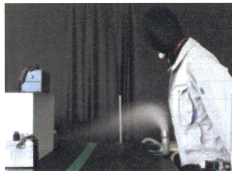
図7.29 実験の様子（フード1、排風量20m 3 /min、位置0.6m）
