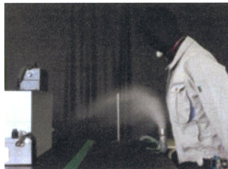
図7.28 実験の様子（フード1、排風量15m 3 /min、位置0.6m）
