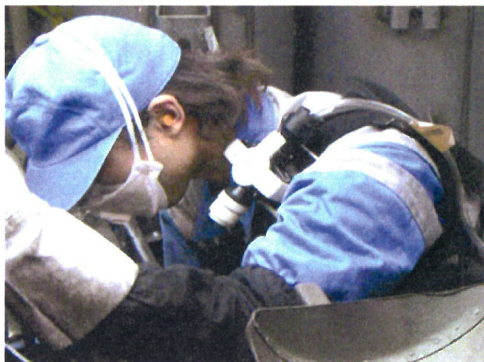
図 2.1 LD-6N デジタル粉じん計の装着状況
