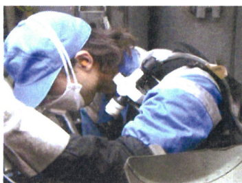
図 3.1 LD-6N デジタル粉じん計の装着状況
