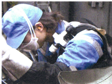
図 3.1 LD-6N デジタル粉じん計の装着状況
