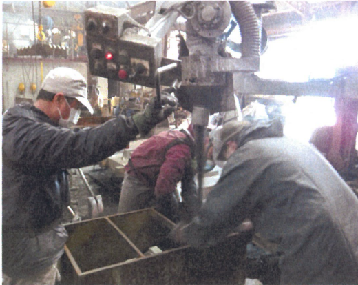
図 2.3 手込め作業風景
