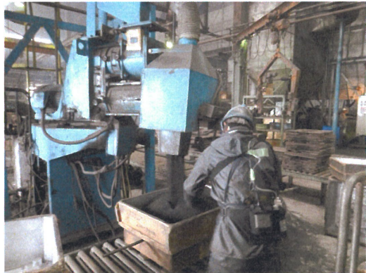
図 2.5 手込め作業風景
