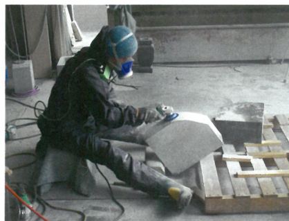
図 1.1 石材に対する研ま・ばり取り作業の様子
