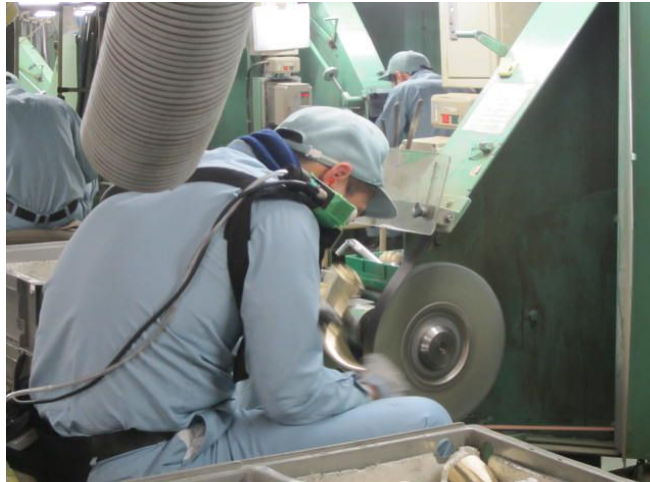
図 4.115 研磨作業の作業状況
