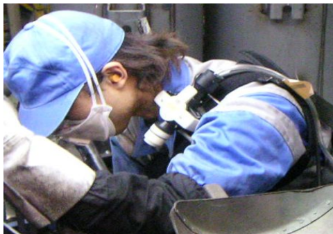
図 2.1 LD-6N デジタル粉じん計の装着状況
