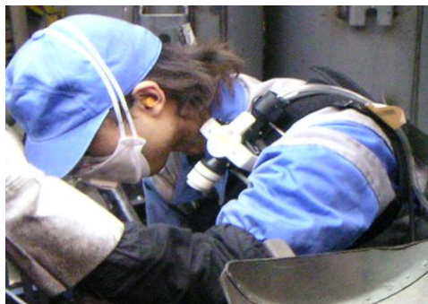
図 3.1 LD-6N デジタル粉じん計の装着状況
