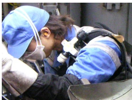
図 1.1 LD-6N デジタル粉じん計の装着状況
