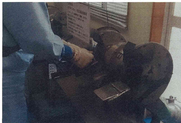
図 4.82 粉じん漏洩濃度測定時の研磨作業状況
