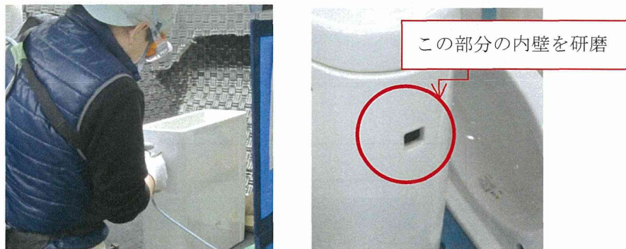
図 4.96 囲い式フードを通常時の 3 分の 1 の吸引風速にした時の作業状況
