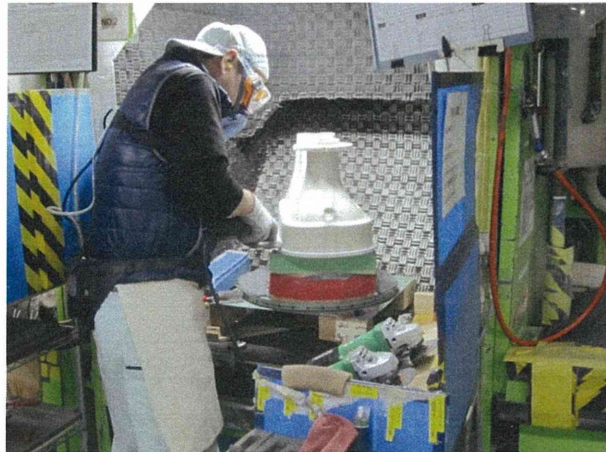
図 4.87 衛生陶器の研磨作業の作業状況
