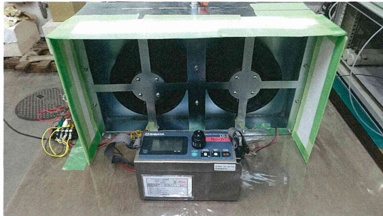
図 4.69 フィルター通過後の濃度測定状況
