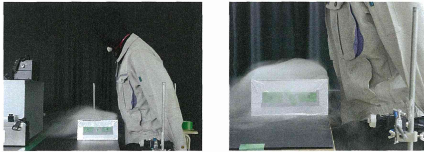
図 4.36 実験の様子（左：全体図、右：測定点⑤に漏洩している時の様子、フード1、排風量 3\text{m}^3/\text{min} 、位置 450\text{mm} ）
