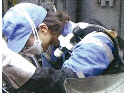
図 1.1 LD-6N デジタル粉じん計の装着状況
