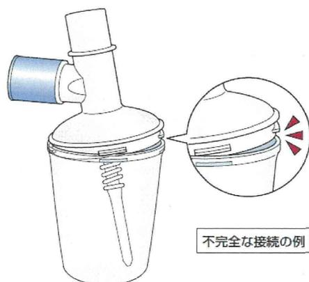
人工呼吸器回路のウォータートラップのカップの接続が不完全であったため、ここからガスが漏れてしまった事例がある。
