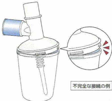
人工呼吸器回路のウォータートラップのカップの接続が不完全であったため、ここからガスが漏れてしまつた事例がある。
