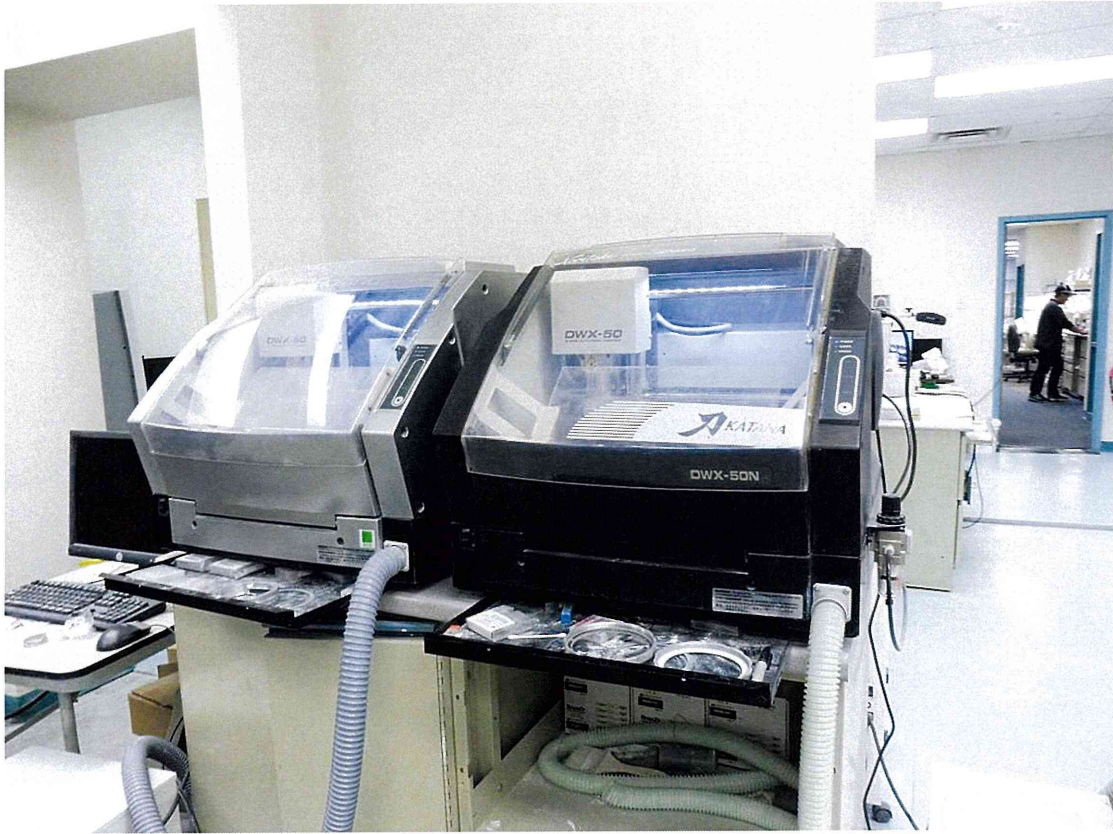
写真 7-3 コンパクトになった新型の CAM 装置 (マサチューセッツ州 E 歯科技工所)
