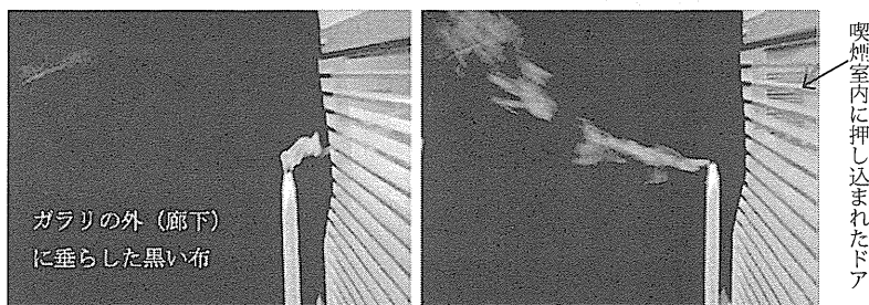
図6 フィゴ作用で押し出されるタバコ煙 (左：ドア開、右：ドア閉)
