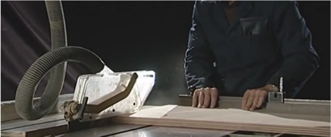
写真 23 ( のこ刃に設置した覆い、英国安全衛生庁が提供している映像の一部 )
