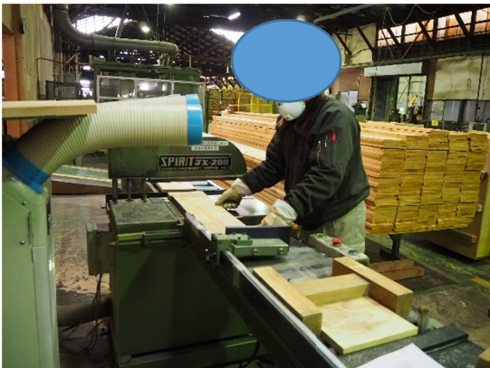
写真7 (板を丸鋸で切断)
