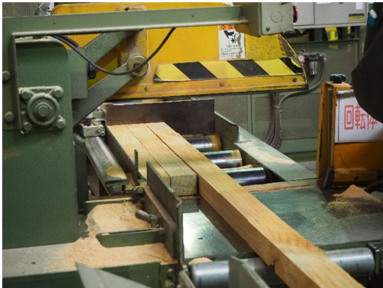
写真 10-2 (角材を丸鋸で切断)
