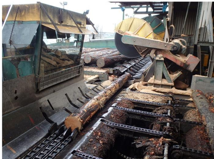
写真7 適切な長さに木材の長さを切りそろえる。
