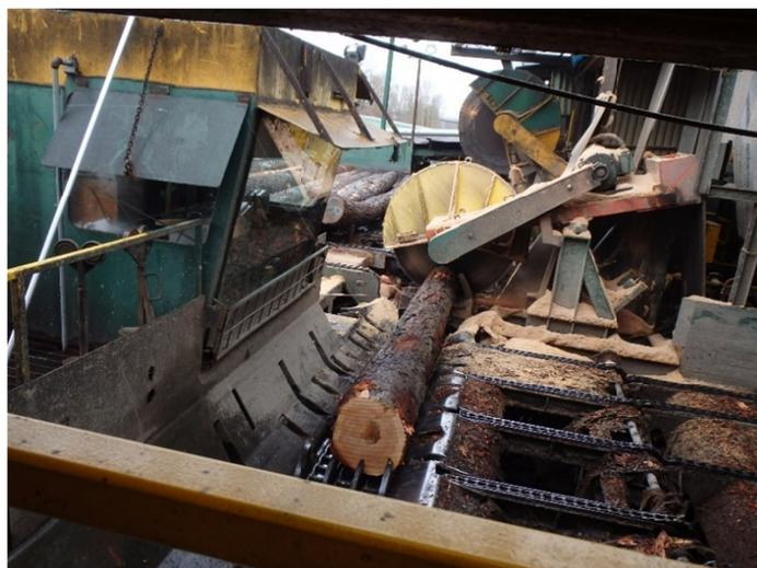
写真 8 適切な長さに木材の長さを切りそろえる。
