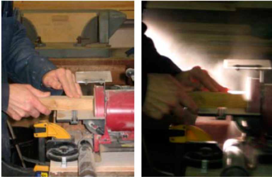
図3 研磨作業によって生じる浮遊粉じんを示すダストランプの有効性。通常は肉眼では確認できない。
