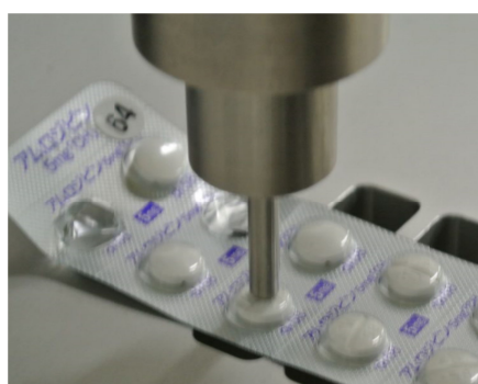
写真 2 開封強度測定の様子
