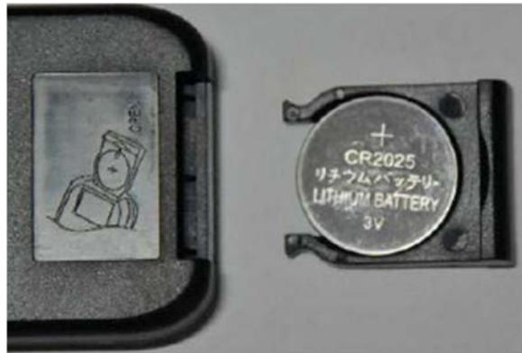
図. 電池室から電池を出す機構（はめ込み式の例<sup>85</sup>）
