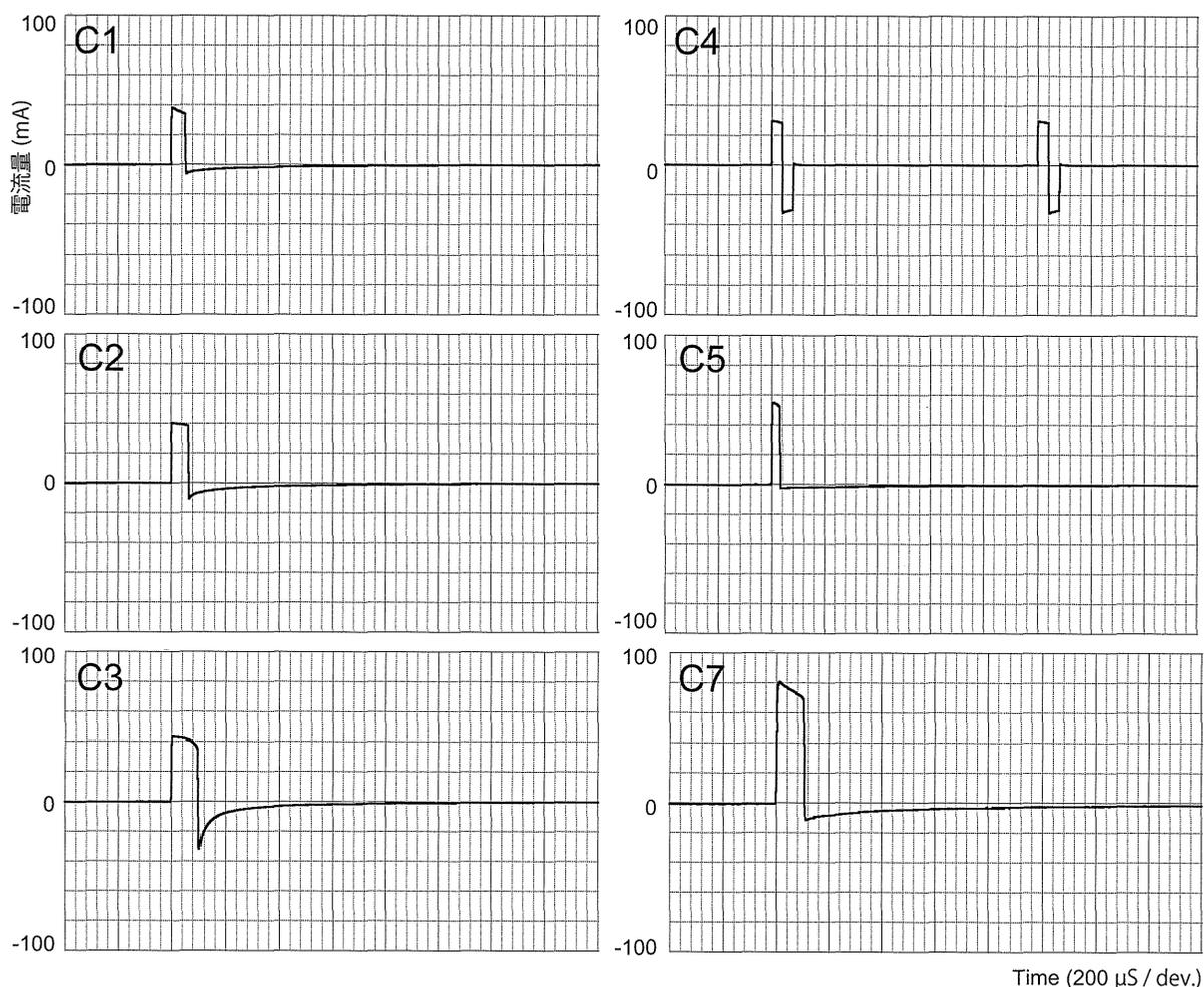
図3 海外機種の出力波形例 (500 Ω固定抵抗負荷時)
