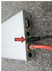
図 6 GW 用 AC アダプタ 図 7 AC アダプタを接続した GW
