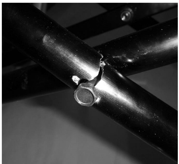
図4. クロスパイプ破損の様子
