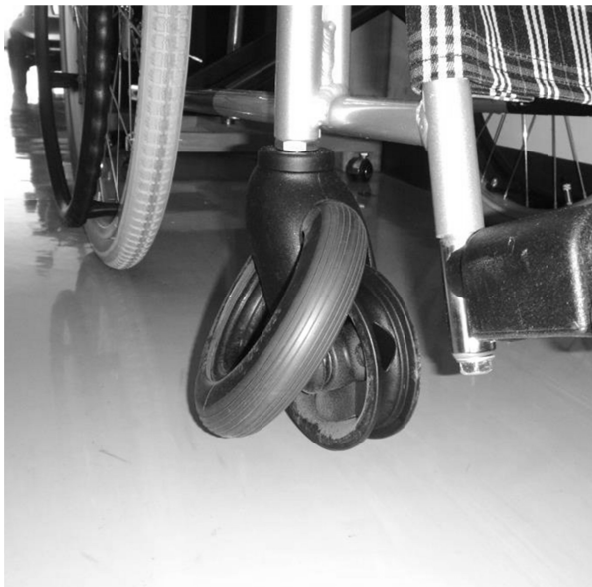
図2. キャスター破損の様子
