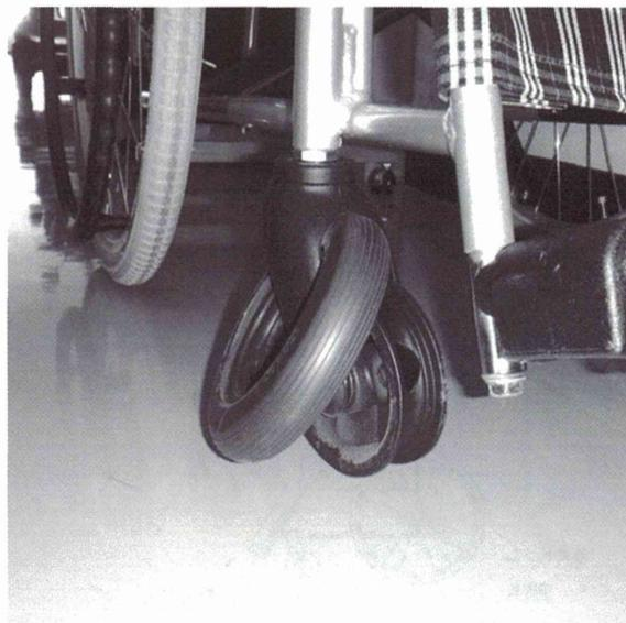
図2. キャスター破損の様子
