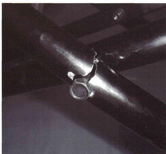
図4. クロスパイプ破損の様子
