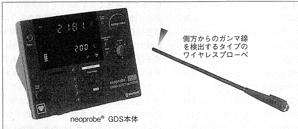
図8 後継機として登場した側方検出型ガンマプローベ 側方からの放射活性を検出できるのみでなく、Bluetooth®によるワイヤレスシステムのため、プローベ(そのまま滅菌可能)と本体を有線でつなぐ必要がなく、操作性が向上している。
