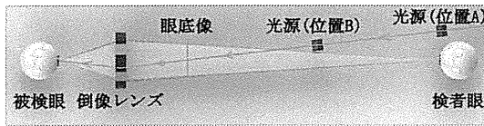
図 4-1 光源を直線的に配置する方法
