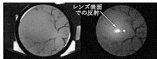
図 5 レンズ側面配置(左)と直線配置(右)での眼底像の比較
