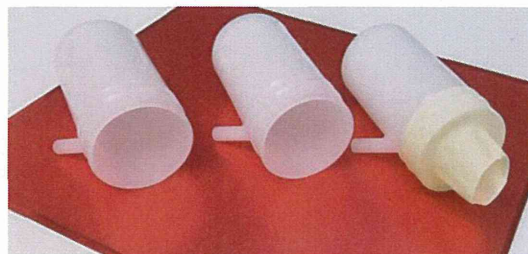
図21 ゴムキャップを装着した実際に用いる指プローブ（右端の成形品）。
