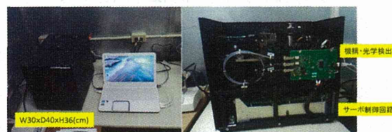
図5 試作した光ディスク蛍光スキャン装置(左図) 試作スキャン装置(右図) 装置内部構成
