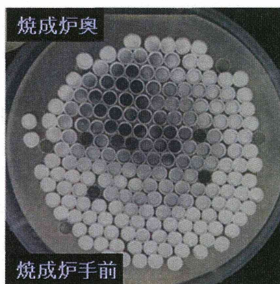
Fig. 28 量産検討機で SiO 2 -NF を焼成した結果 (4 インチウエハー)
