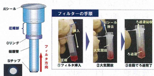
Fig. 20 新規ろ過機構の模式図とそのフィルター手順
