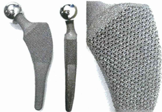
図 3 電子ビーム金属粉末積層造形法により作成した大腿骨インプラント
