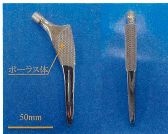
図1 三次元積層造形法で近位表面加工部を作製し拡散接合にて接合させた大腿骨インプラント
