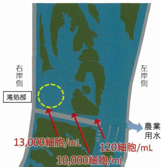
図3 磯部頭首工の概要図及び5/23における S. acus の検出状況
