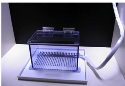
プレパルス驚愕反応抑制試験：突発的に大きな音刺激をマウスに呈示したときに生じる反射（全身の筋肉収縮）による体動を、加速度計や静電気検出器などによって測定する試験。
