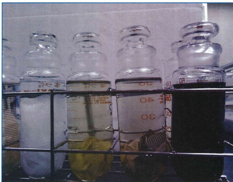
図 3 アセトン超音波抽出後の試料液
