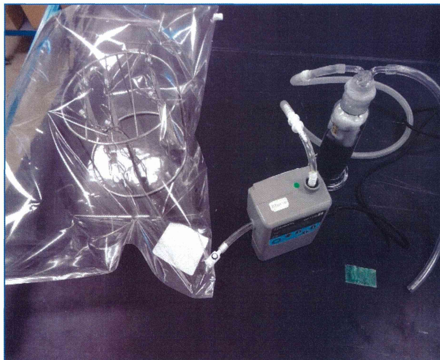
図5 サンプリングバック法による放散試験
