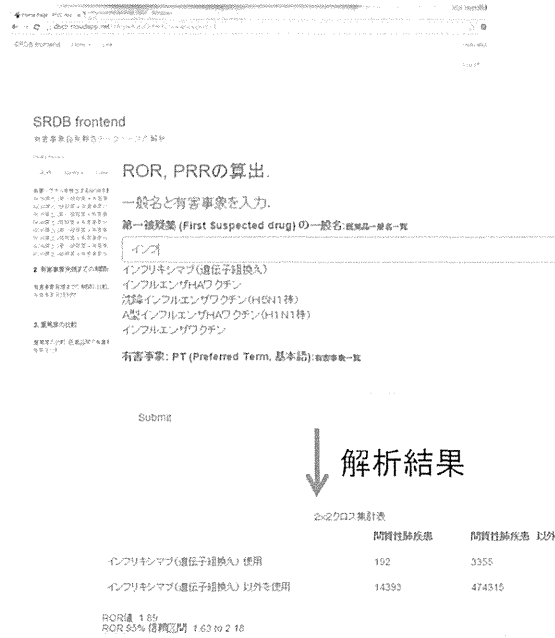
図 1-29. 作成した JADER リレーショナルデータベース作成, 管理ソフトウェア (a) と web ベース有害事象解析システム. a) PMDA で公開されている CSV ファイルから RDB を作成し, 着目すべき任意のレポートを抽出できる. b) 様々な解析を web ベースで行うことができる.
