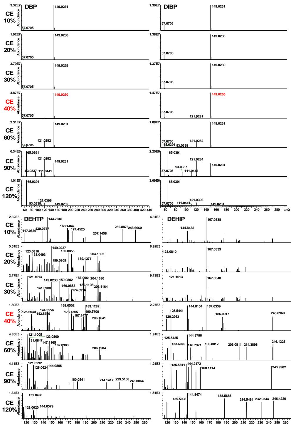
図9  $m/z$  205.8853 をプリカーサーイオンとしたときの DBP(左上)、DIBP(右上)、DEHTP(左下)および DEHIP(右下)の各 CE 条件における MS/MS スペクトル
