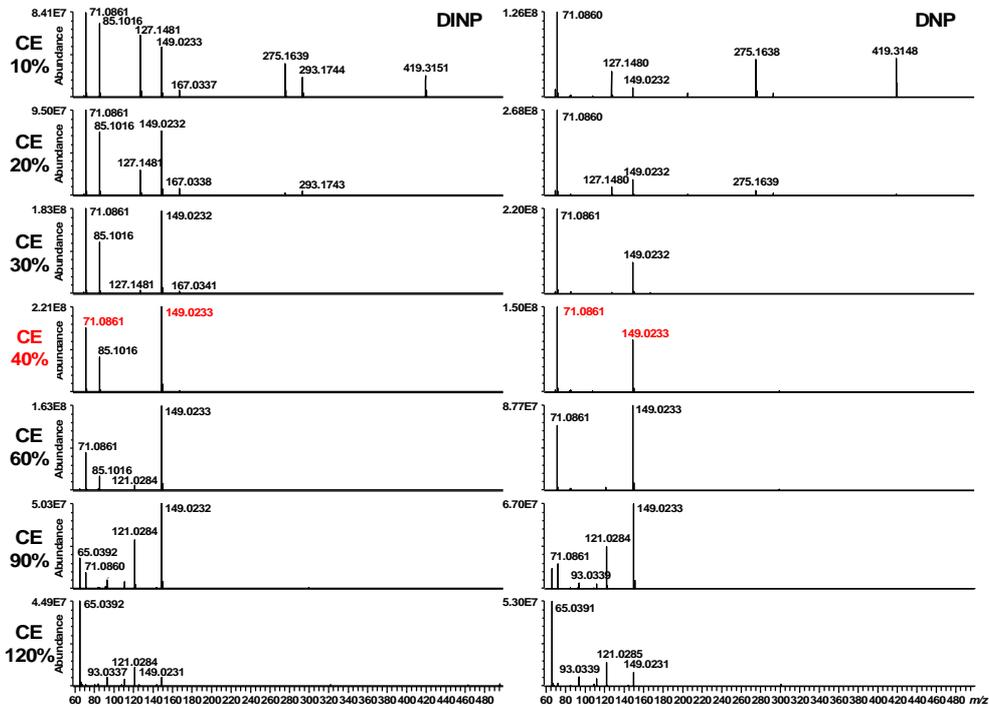
図14  $m/z$  419.3150 をプリカーサーイオンとしたときの DNP(左)および DNP(右)の各 CE 条件における MS/MS スペクトル
