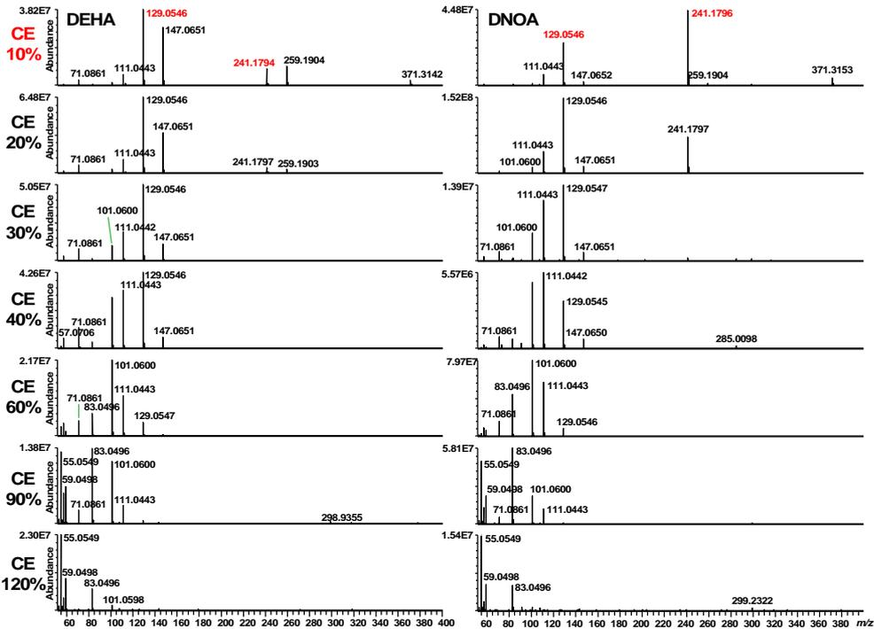
図10  $m/z$  371.3152 をプリカーサーイオンとしたときの DEHA(左)および DNOA(右)の各 CE 条件における MS/MS スペクトル
