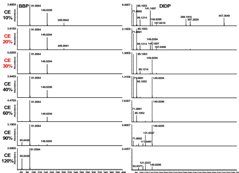
図 16  $m/z$  313.1487 をプリカーサーイオンとしたときの BBP (左) および  $m/z$  447.3547 をプリカーサーイオンとしたときの DIDP (右) の各 CE 条件における MS/MS スペクトル
