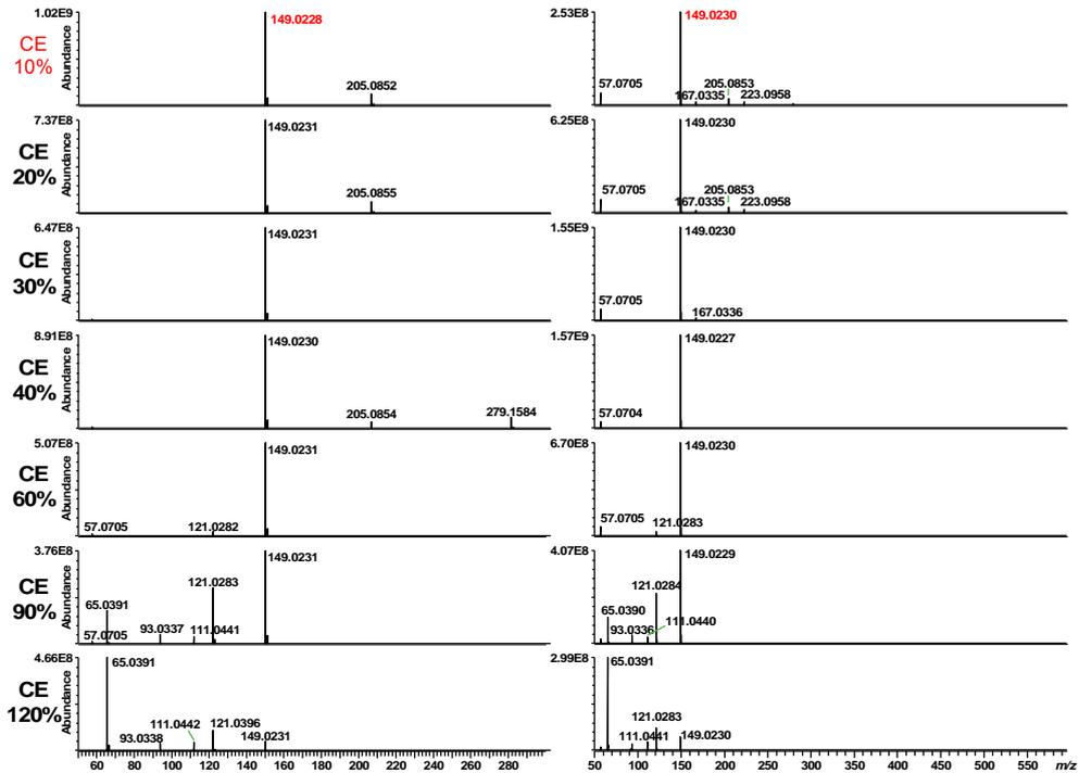
図7  $m/z$  279.1582 をプリカーサーイオンとしたときの DBP(左)および DIBP(右)の各 CE 条件における MS/MS スペクトル
