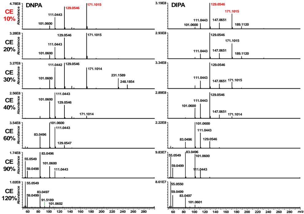
図5  $m/z$  231.1586 をプリカーサーイオンとしたときの DNPA(左)および DIPA(右)の各 CE 条件における MS/MS スペクトル
