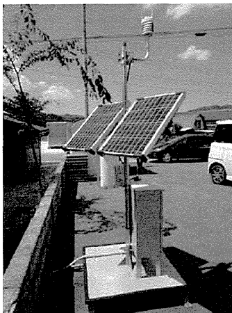
写真5 川内村に設置した小電力無線を活用した無人・自動化放射線計測装置
