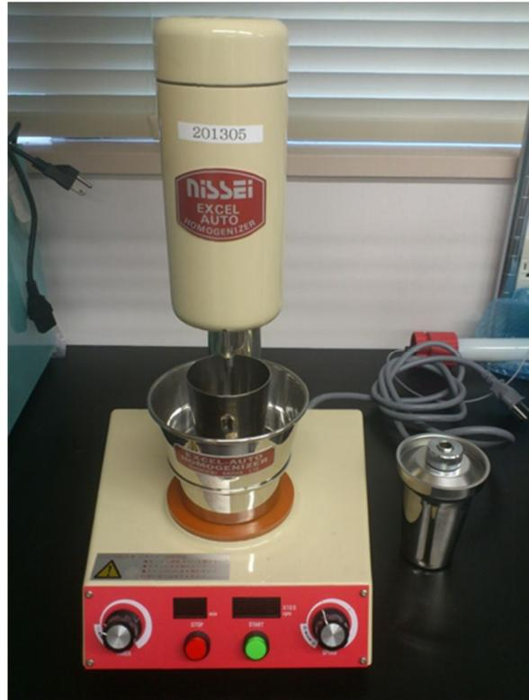
図 2 . 実験に使用したホモジナイザー (Excel Auto Homogenizer, NiSSEi)
